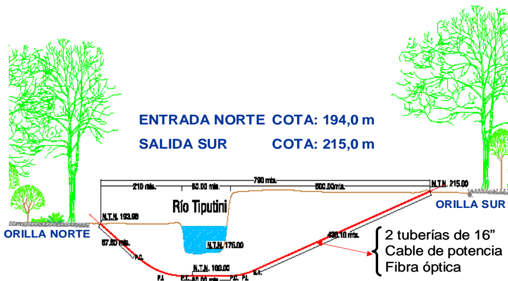
FIGURA 4.3-3: ESQUEMA DEL CRUCE SUBFLUVIAL DEL RÍO TIPUTINI
